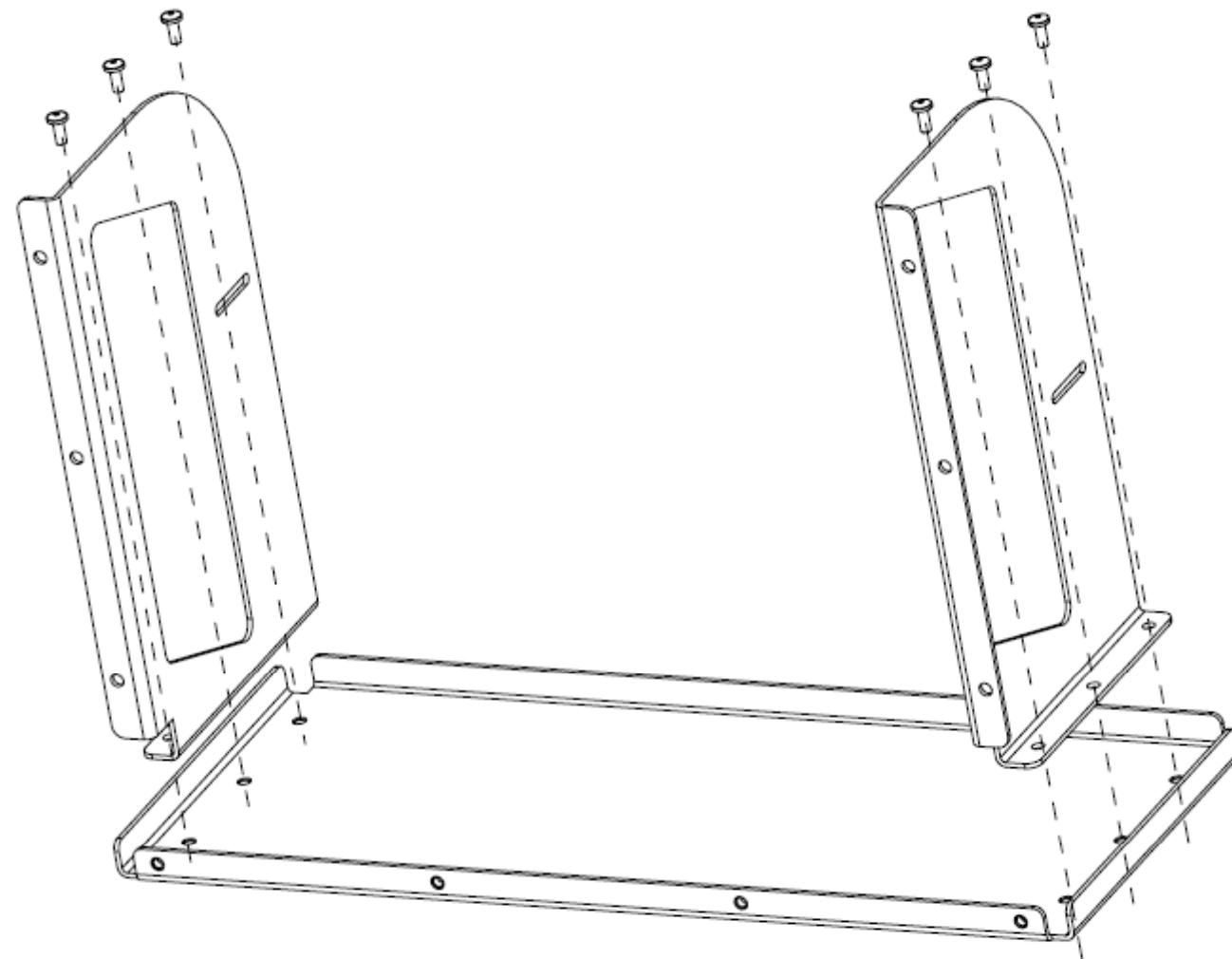
3,安装五金前面板：将五金前面板用10颗M4X10螺丝固定在上一步装好的框架上。
