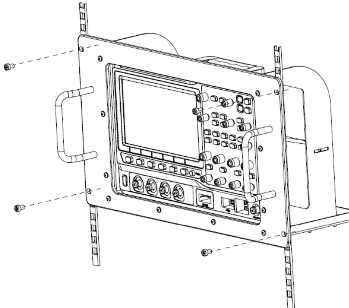
6,安装后注意：机架占6U的高度，箭头所指的孔为机架的安装孔，注意对准安装。
