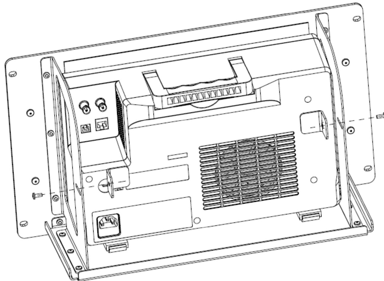
5,装入机柜：用两颗M6螺丝和两颗M6方螺母将固定好的仪器的支架安装在标准19英寸的机柜上。
