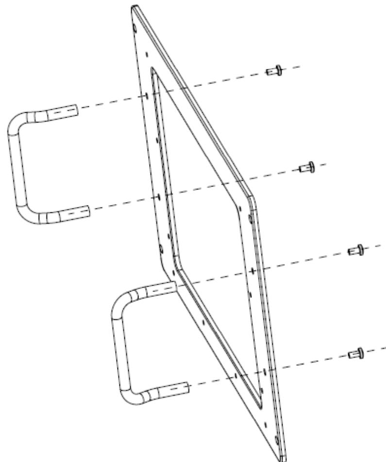
2,安装五金左，右板：五金左，右板对准五金底板的孔，用六颗M4X6螺丝来将其固定.
