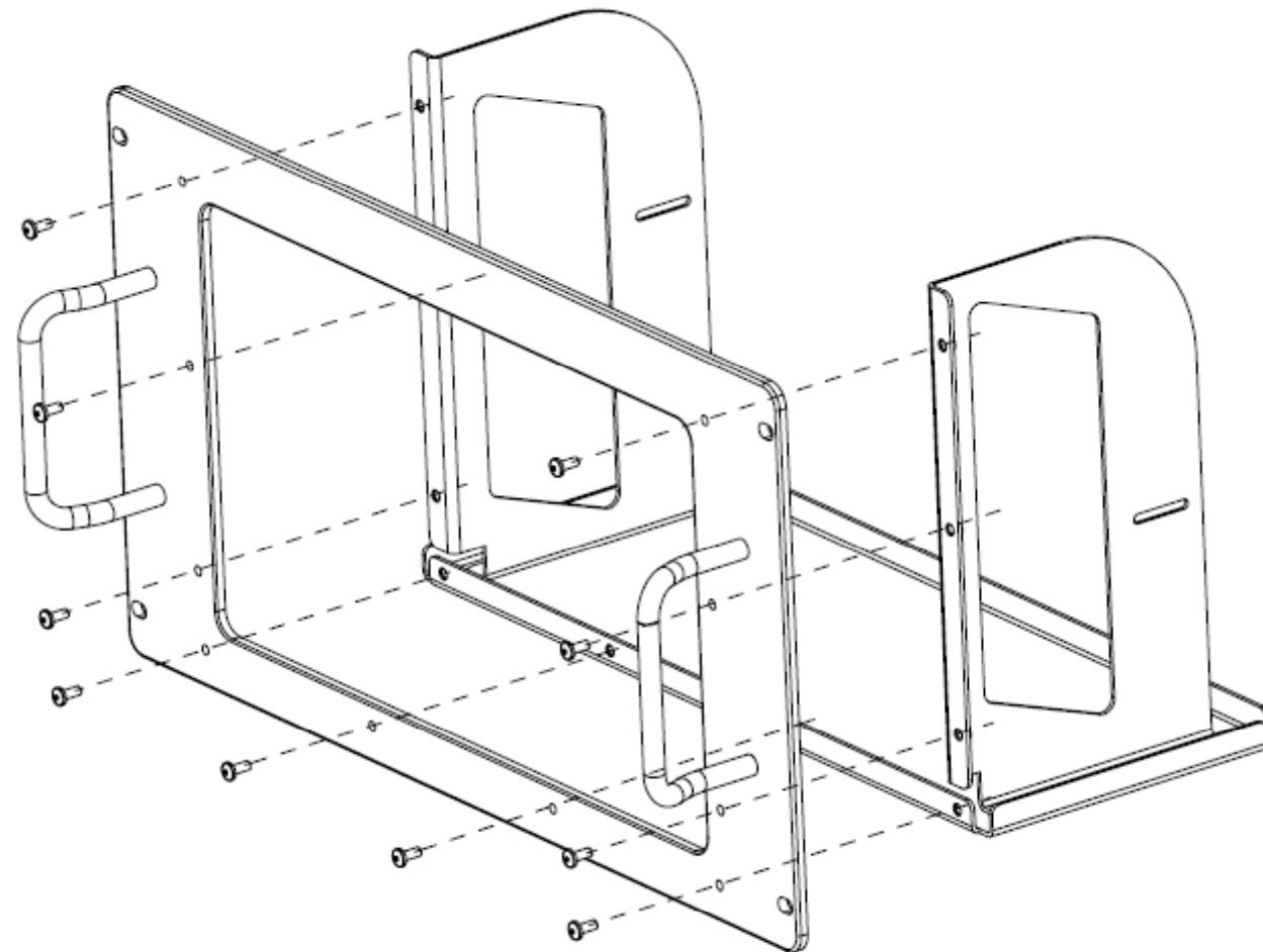
4,固定仪器：用两个固定件把仪器压紧，用2颗M4X10螺丝来固定。
