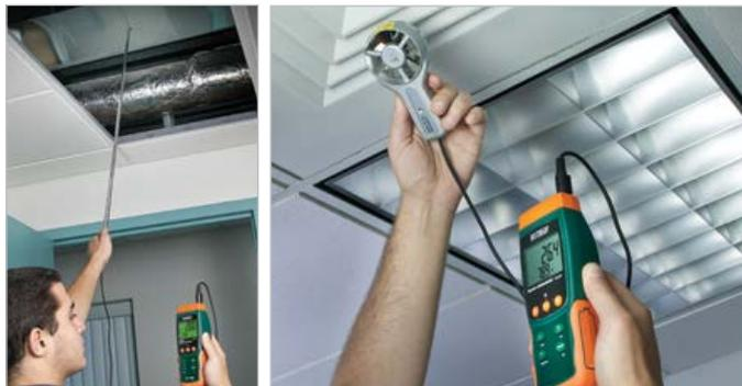
**AN300/AN310 Large Vane CFM/CMM Thermo-Anemometers**
