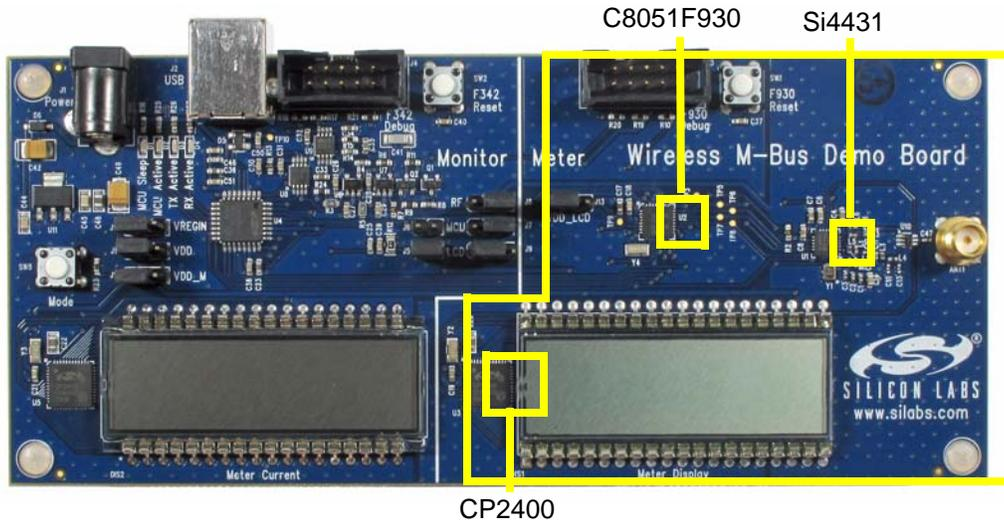
**Figure 2. Meter Section**
