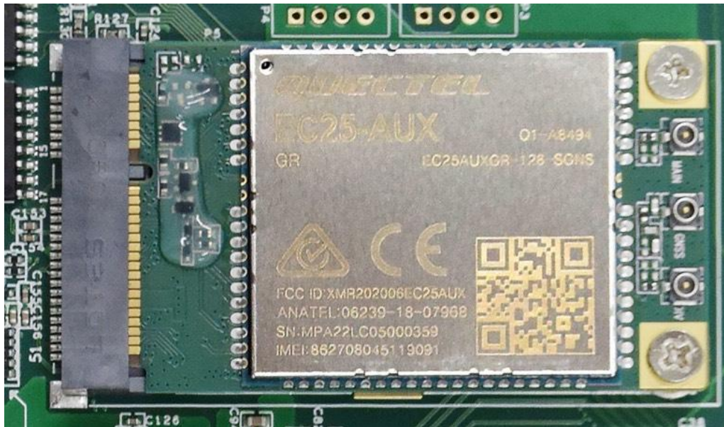
mini-PCIe Connector & 4G/LTE Module
