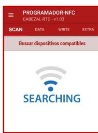
L'onglet SCAN permet de lire les données déjà enregistrées dans l'équipement. En plaçant l'appareil en contact avec le mobile, ce dernier reconnaîtra automatiquement le modèle. L'APP émet un son de notification dès qu'elle détecte l'équipement et ses paramètres.
