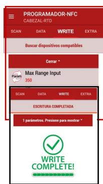
Pour charger la nouvelle configuration dans l'appareil, nous devons accéder à l'onglet WRITE où nous verrons les paramètres que nous avons modifiés. C'est là que nous placerons à nouveau le mobile en contact avec l'appareil jusqu'à ce que nous entendions la notification que l'opération est terminée.
