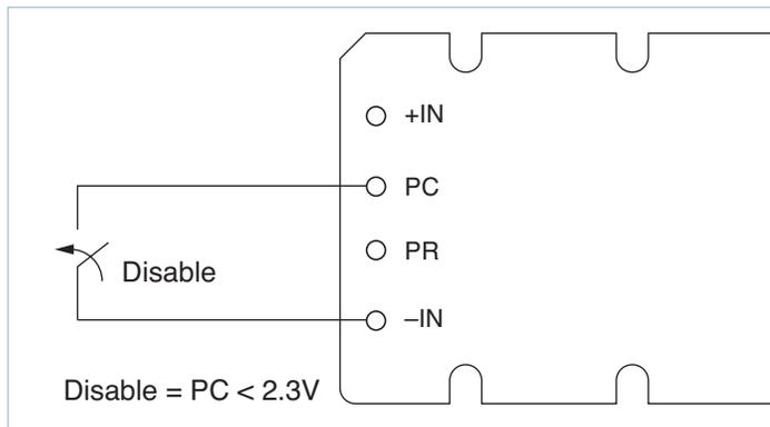
Figure 2 — Module enable/disable
