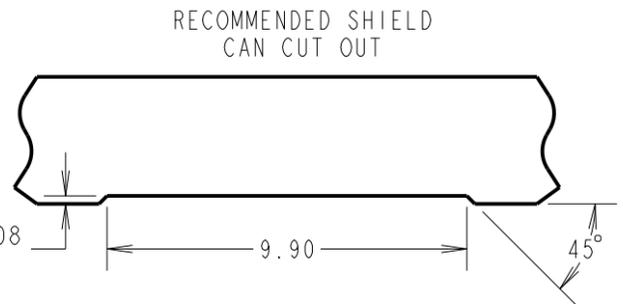
RECOMMENDED SHIELD CAN CUT OUT
