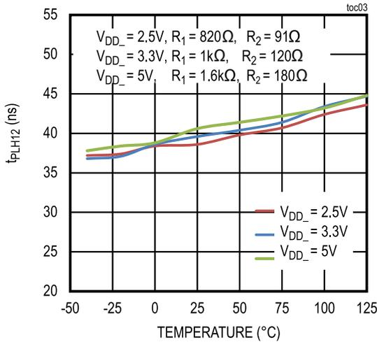
**PROPAGATION DELAY  $t_{PLH21}$
