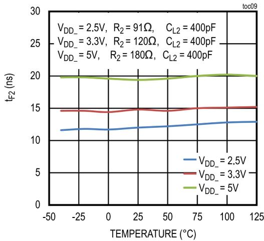
$t_{F2}$  MEASURED FROM  $0.7V_{DD2}$  TO  $0.3V_{DD2}$
