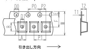
・シールテープ 剥離強度 The force to peel away the fixing seal tape 0.1~1.0N
