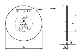
単位 Unit: mm A  $\phi$  330  $\pm$ 2 B 17.5  $\pm$ 0.5 C 21.5  $\pm$ 1 D  $\phi$  80  $\pm$ 1 E  $\phi$  13  $\pm$ 0.2 F  $\phi$  21  $\pm$ 0.8
