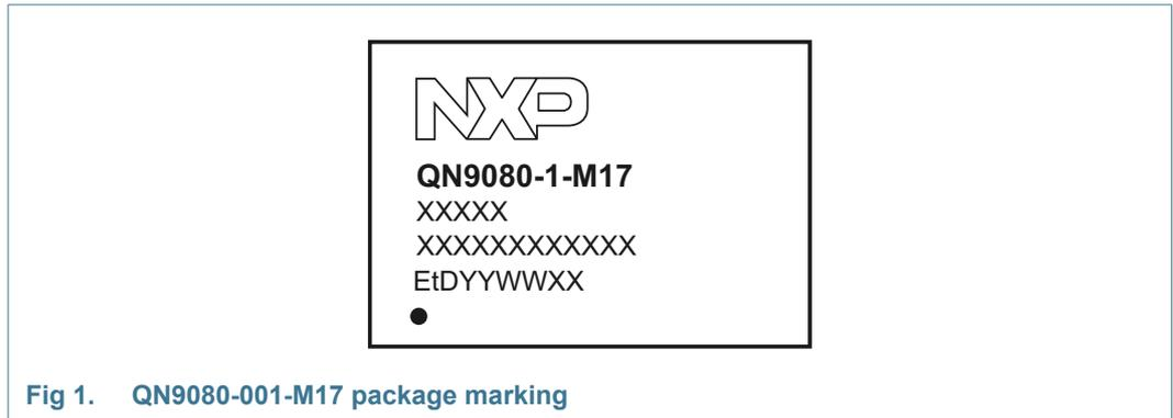
**Fig 1. QN9080-001-M17 package marking**
