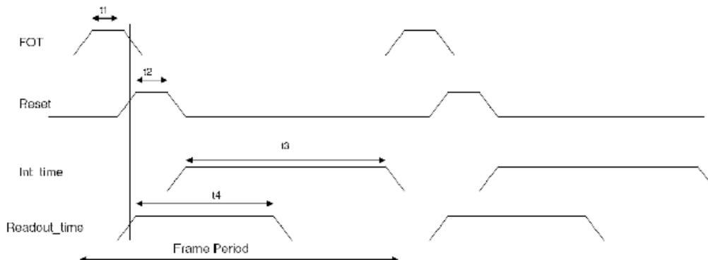
**Figure 23. Timing Diagram**
