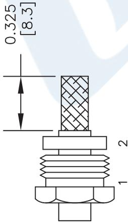
FORM BRAID OVER CLAMP NUT (3). TRIM BRAID BACK TO SHOULDER. CUT DIELECTRIC TO DIMENSION SHOWN. DO NOT NICK CENTER CONDUCTOR. SOLDER CONTACT TO CENTER CONDUCTOR. REMOVE EXCESS SOLDER. DO NOT OVER HEAT DIELECTRIC. INSERT CABLE ASSEMBLY INTO BODY & TIGHTEN.
