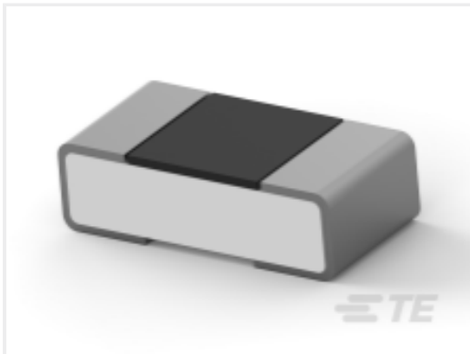
TE Part #5-2176360-6 RQ 0402 1K62 0.1% 10PPM 1K RL
