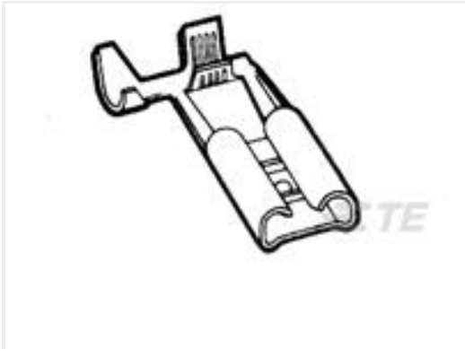
TE Part #180464-5 250 FASTON,FLAG,REC.,14-17AWG, LATON
