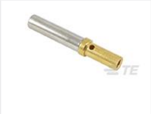
TE Part #0462-201-1631 SOC, SOLID, SIZE 16, 16-20AWG, AU
