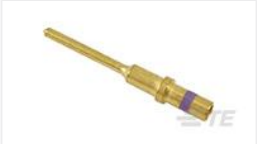
TE Part #0460-010-2031 PIN, SOLID, SIZE 20, 16-18AWG, AU
