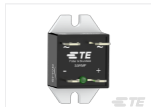
TE Part # 1-2323802-1 SSRMP-480D25R = Mini Puck, 25A, 480V AC, R
