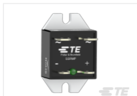
TE Part # 2323802-1 SSRMP-240D25 = Mini Puck, 25A, 240V AC
