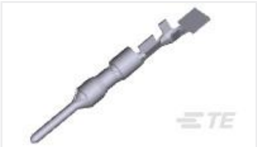
TE Part #1-794224-0 MINI UMNL2 PIN 30-26AWG LP LF
