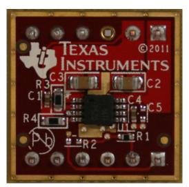
Figure 1. SMP-TPS7A3001-MVK Submodule
